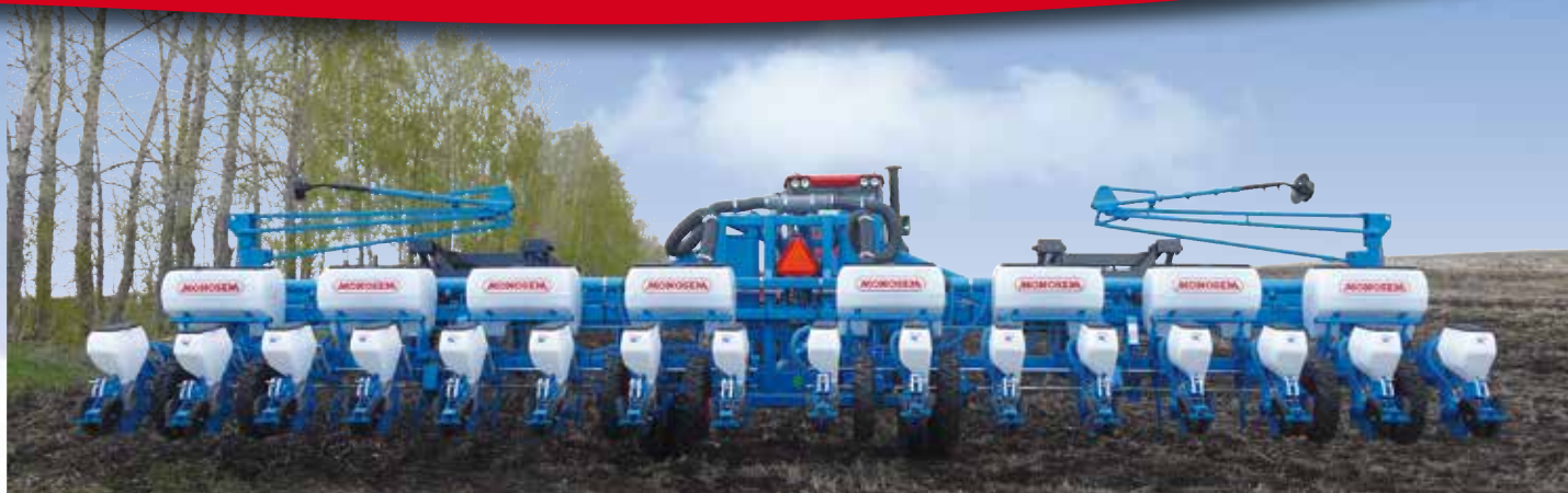
NC Technic mais zaaimachine - 16 rij op 70 cm Gekoppeld twee starre frames dubbel balk 8-rij met kunstmest 4 x 175L met meskouters op werktuigendrager.
