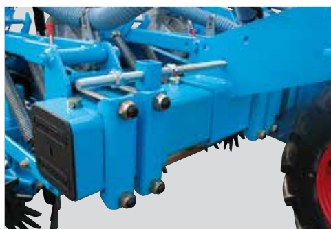
Boven de uitschuifbare balk zitten de aanslagen waar de rijafstand op elke gewenste breedte kan worden ingesteld.
