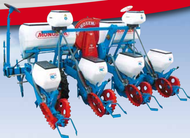
NC Classic V1 zaaimachine 4-rij Monobar star frame (75 cm) Microsem en kunstmest opbouw 2x175 L met meskoueters
