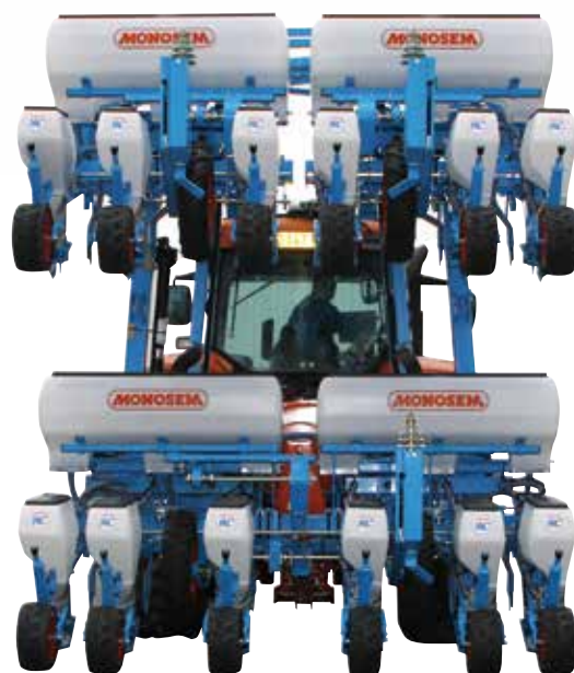
* Voorbeeld van een CRT frame transportstand op 3 mtr
