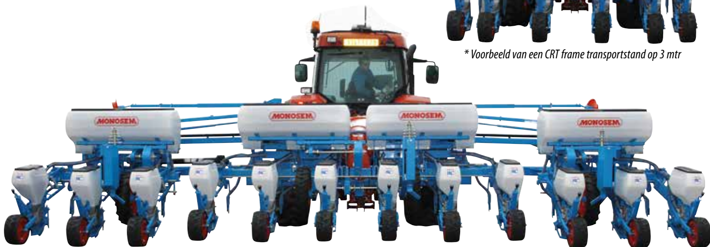
NC Classic V2 zaaimachine - 12 rij op 75 cm Opklapbaar CRT frame - opgeklapt 3 mtr *
